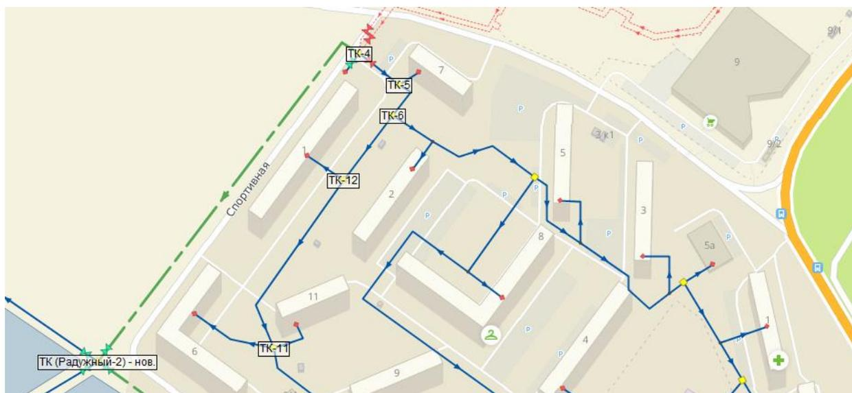
Рисунок 5. Тепловод-перемычка от Радужный-2 до ТК-4 «Радужный-1»
