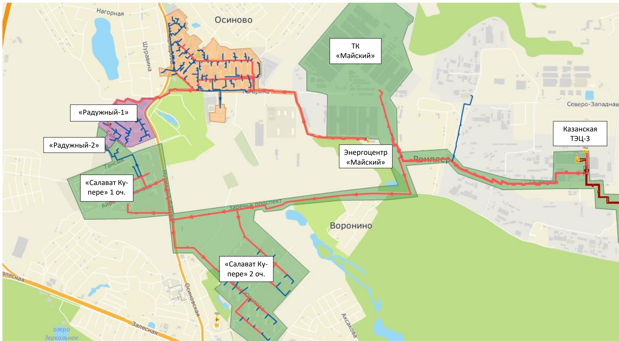
Рисунок 20. Электронная модель тепловых сетей СЦТ1, СЦТ2, Салават Купере, ТК «Майский»
