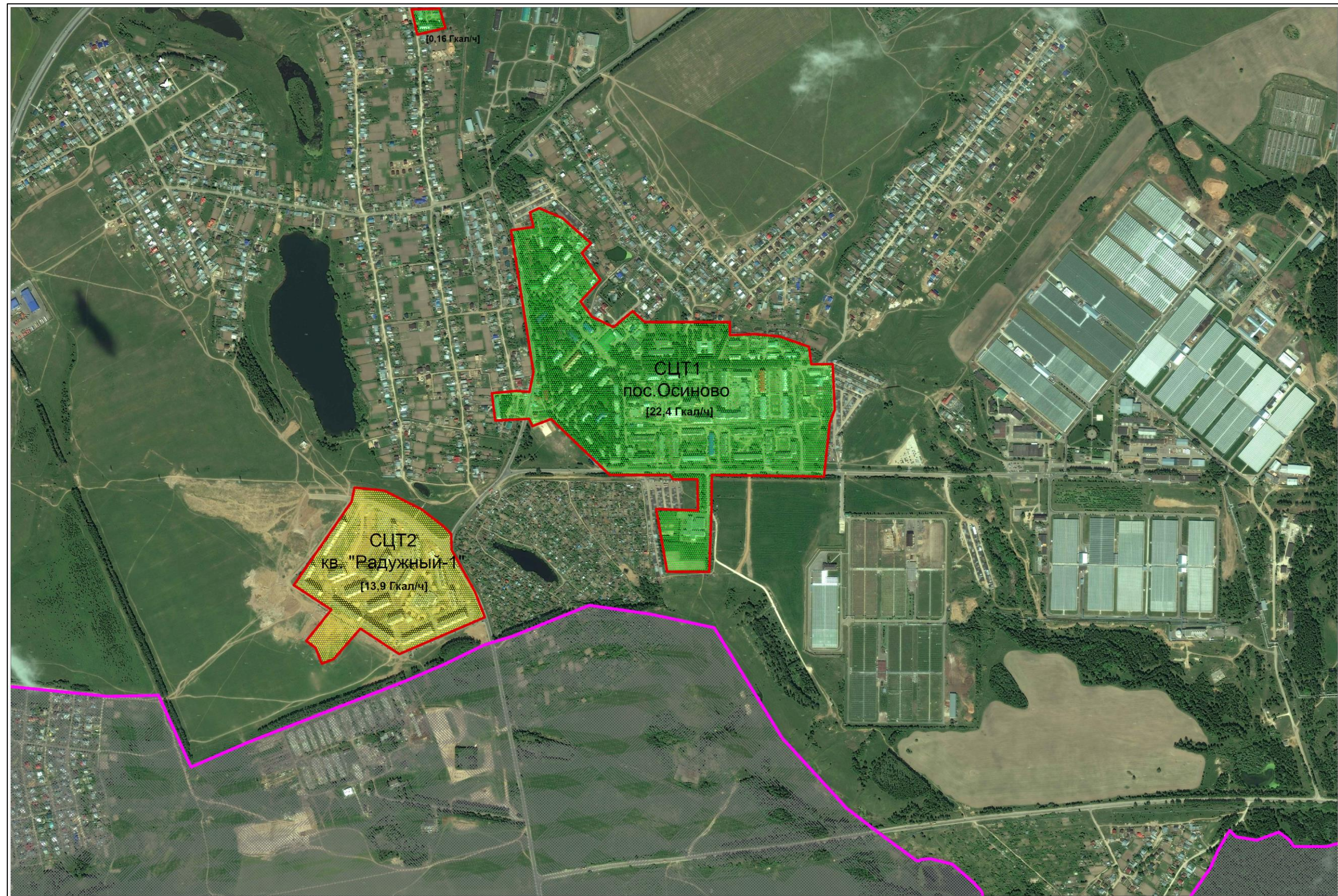
рис. 15 - Зоны действия систем централизованного теплоснабжения КТЭЦ-3
