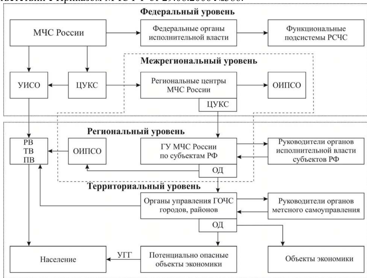
Рисунок 11.1 Схема организации информирования населения о прогнозируемых и возникших чрезвычайных ситуациях и пожарах.
